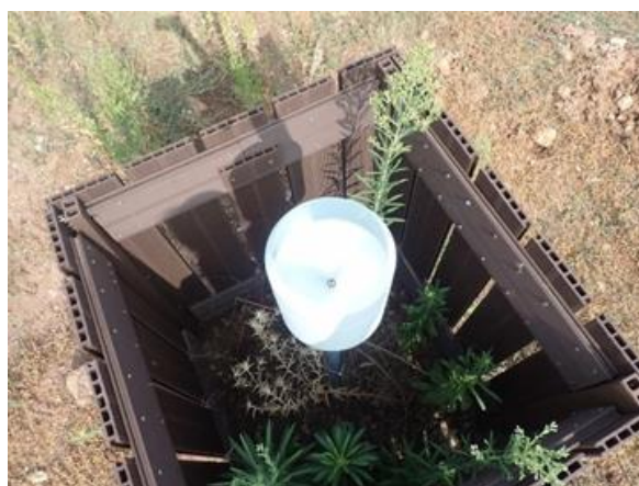
Illustration 26 : Pluviomètre enregistreur installé sur le dépôt du Lenté - Fonsante - Tanneron (83).
