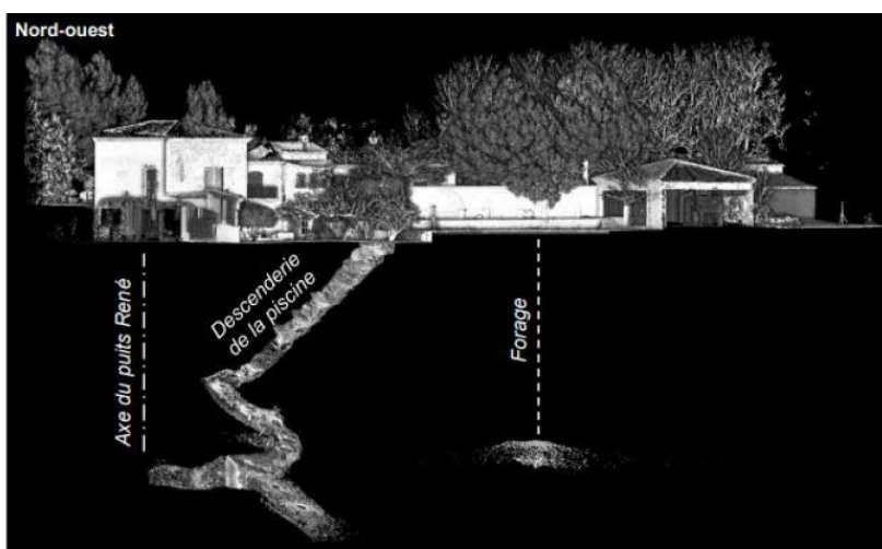
Illustration 31 : Vue en perspective du relevé de la surface et des travaux souterrains (dirigé vers le nord-est) -13 (doc. GEODERIS).
