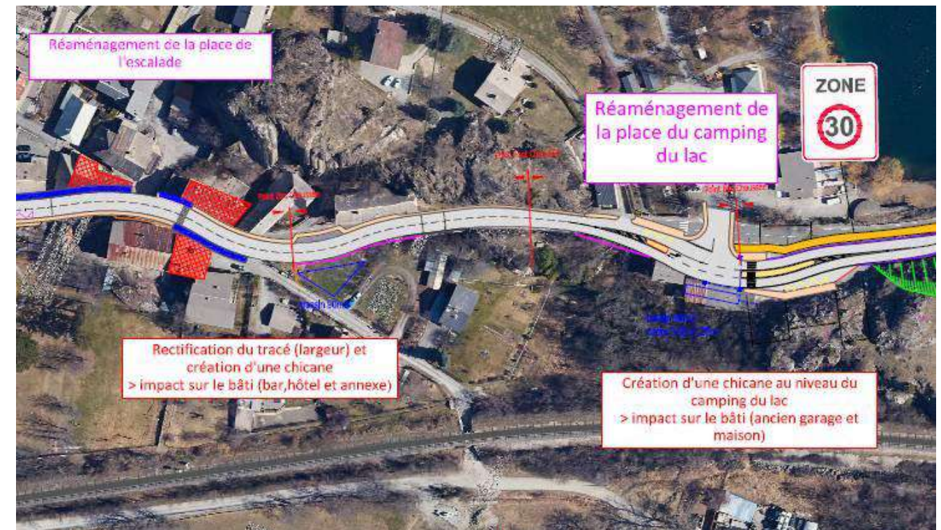
Figure 3 : Synoptique du projet dans la partie centrale
