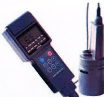
Figure 23 : Exemple de turbidimètre
