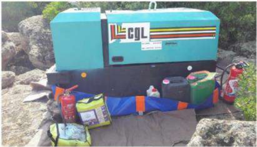
Exemple du stockage d'un compresseur et de petit matériel au-dessus d'une falaise avec bac de rétention et tapis absorbant
