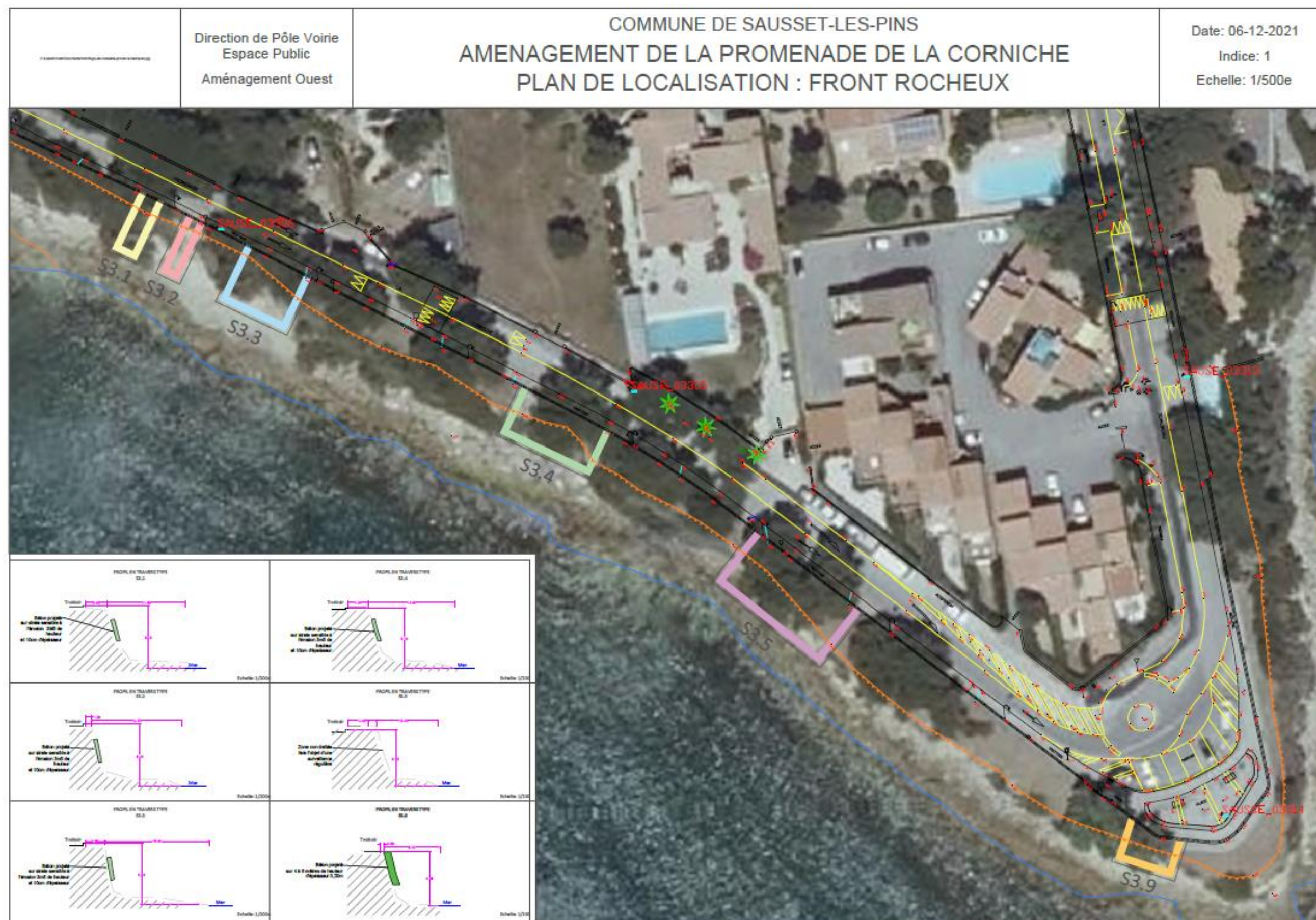
Figure 21: Secteurs faisant l'objet de travaux de sécurisation et profils en travers (Source : MAMP)
