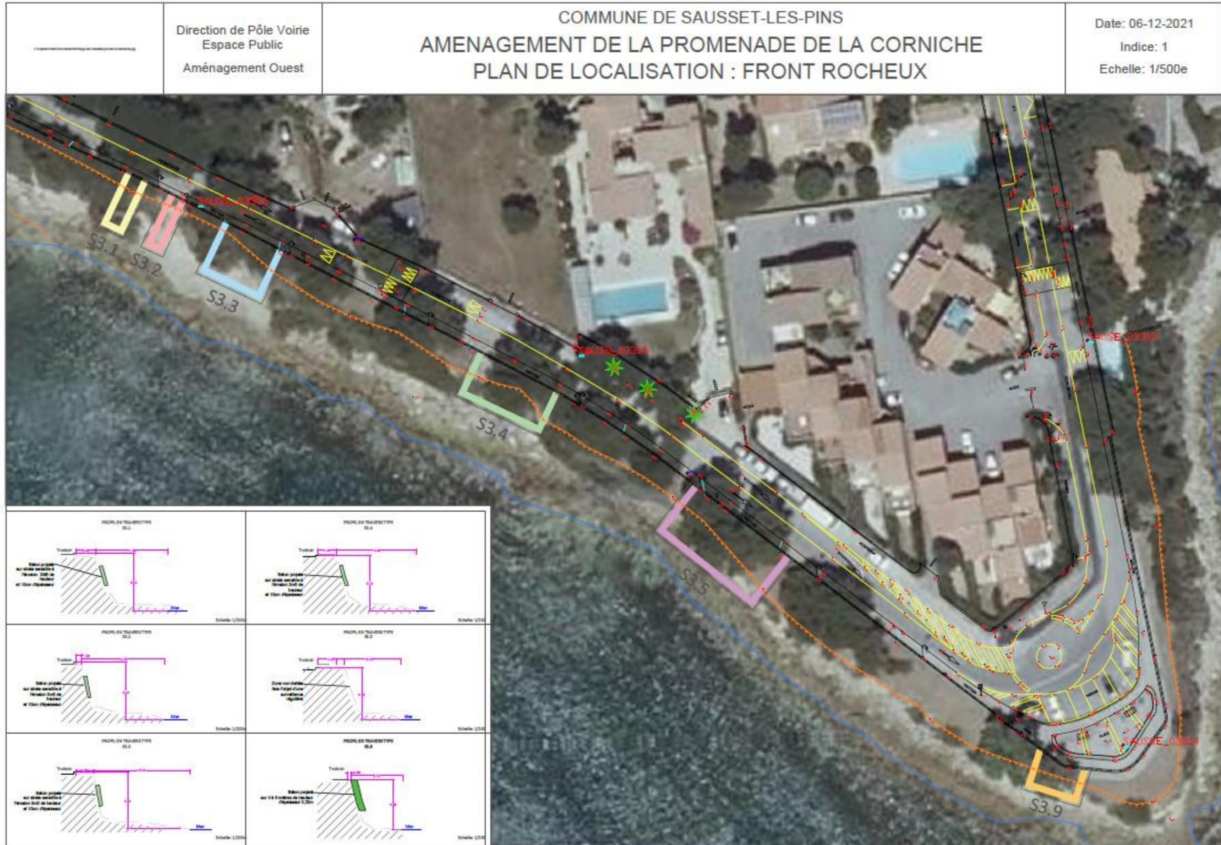
Figure 6: Secteurs faisant l'objet de travaux de sécurisation et profils en travers (Source : MAMP)
