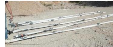
*Barres d'ancrage équipées de chaussette géotextile (Photo : Naturalia)*
