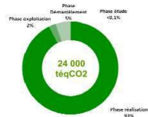
Figure 4-1 : Bilan Carbone® d'une ferme solaire photovoltaïque dans le Sud de la France, émissions en téqCO<sub>2</sub> et leur répartition pour chacune des phases de vie du projet.
