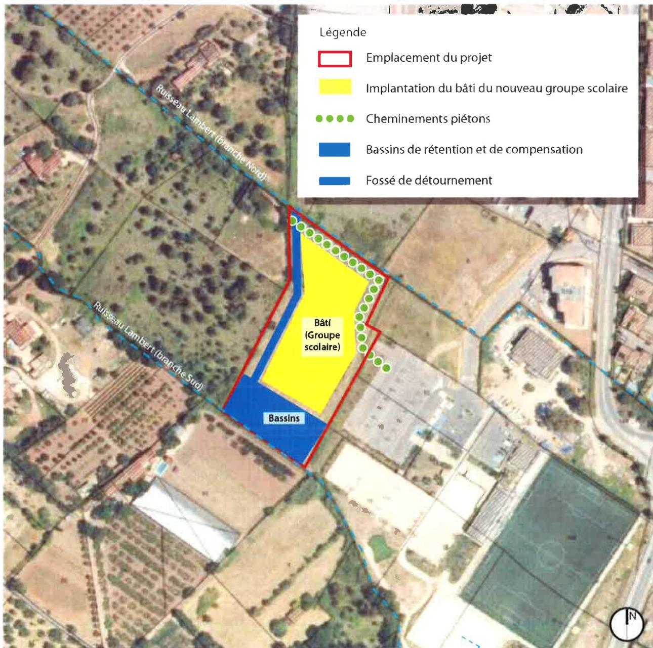
**Plan de principes des aménagements hydrauliques**
