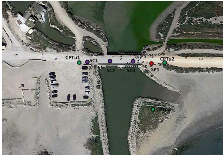
Figure 10 : Implantation des sondages géotechniques réalisés par Fondasol 2016
