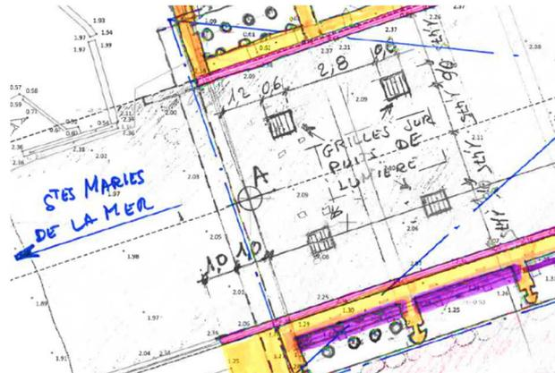
Figure 15 : Puits de lumière sur les passes à poissons
