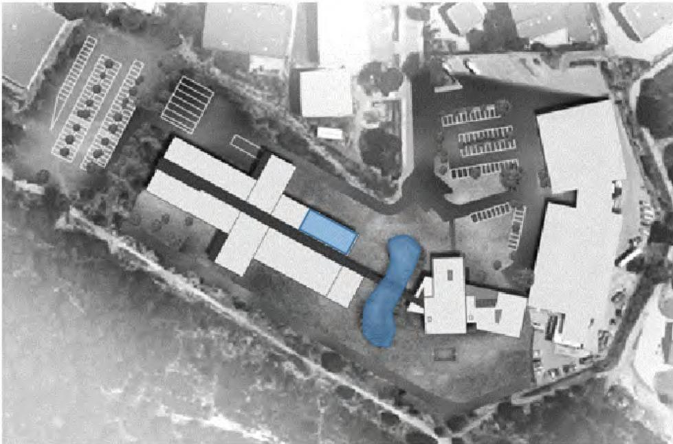
Figure 10 : bassin de rétention et noue filtrante
