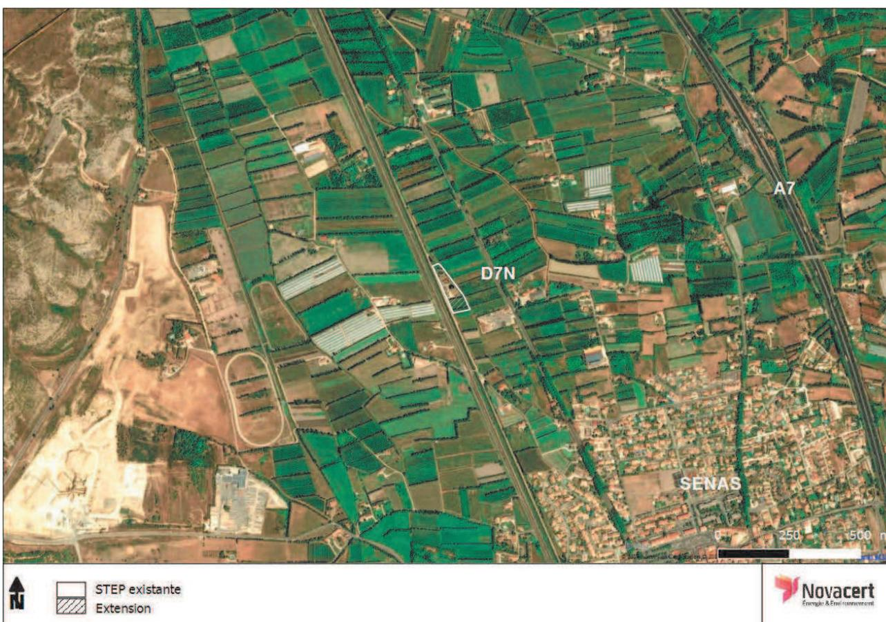
Le projet consiste en l'extension de la station d'épuration (STEP) de Sénas. De nouveaux équipements seront créés à proximité immédiate de l'actuelle STEP. La nouvelle station sera en mesure de traiter 6 600 EH en moyenne et 11 000 EH en pointe, soit 660 kg/j de DBO5. Ces valeurs sont cohérentes avec les prévisions de croissance de la commune.
