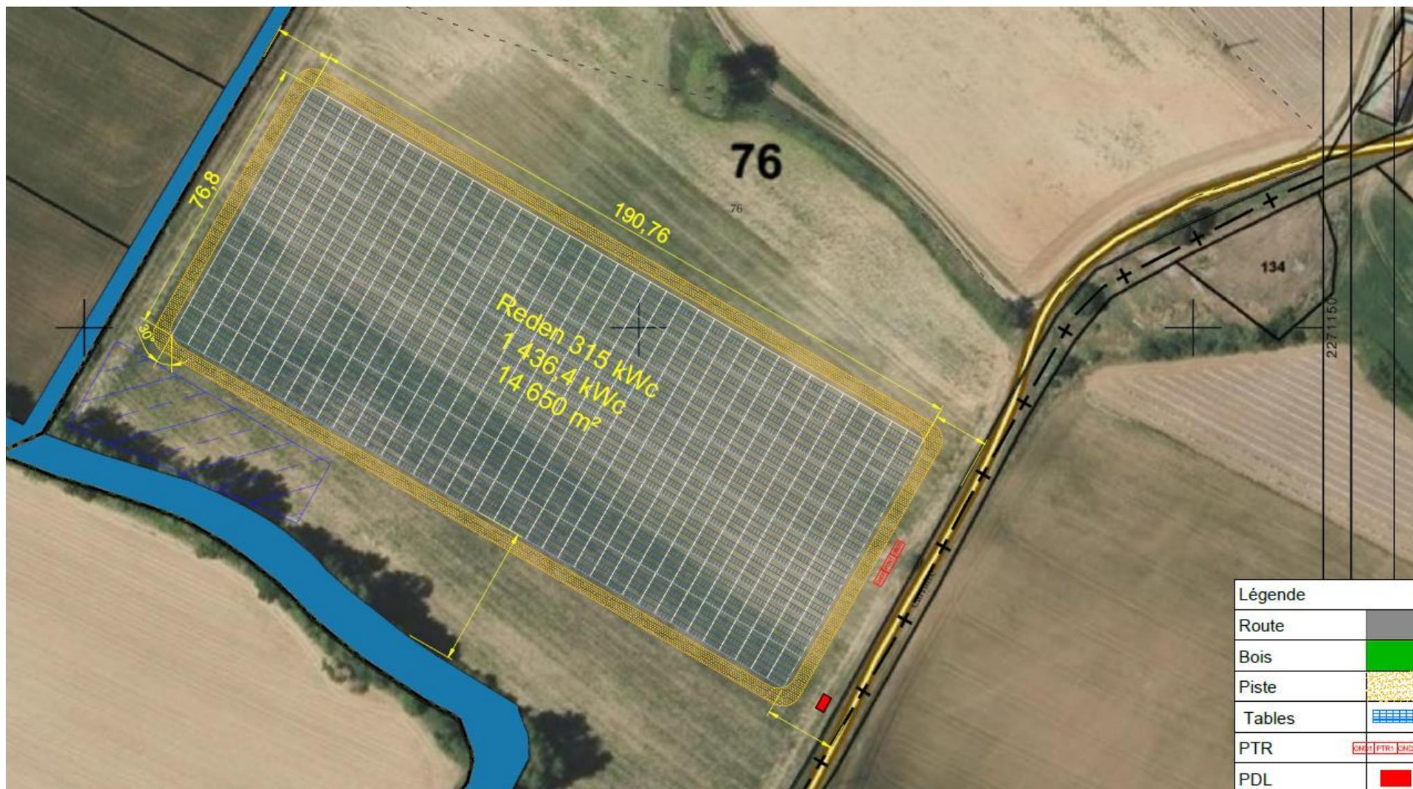
Figure 1 : Plan d’implantation de la serre
