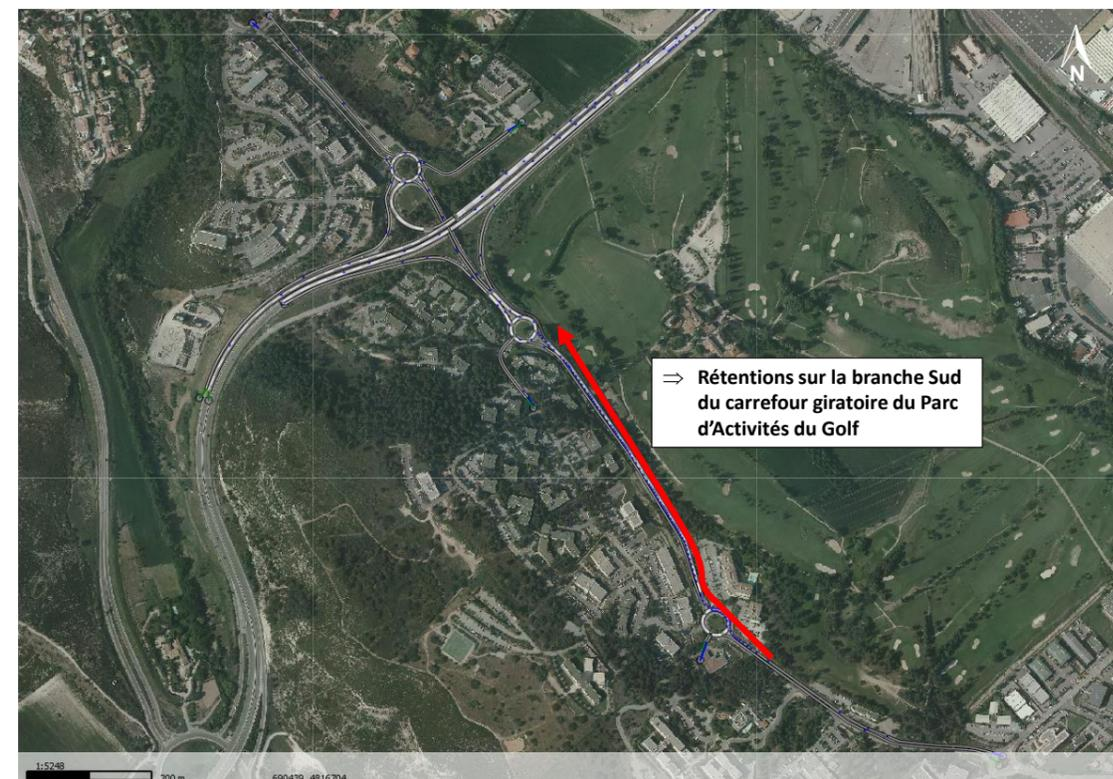
Scénario 2 : Elargissement à 2 voies sur 50 mètres supplémentaires et allongement de la bretelle de sortie de la RD9 depuis Aix en Provence sur 150 mètres
