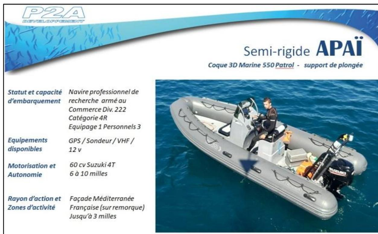
Figure 5 –Semi-rigide APAÏ ; embarcation professionnelle (P2A Développement)
