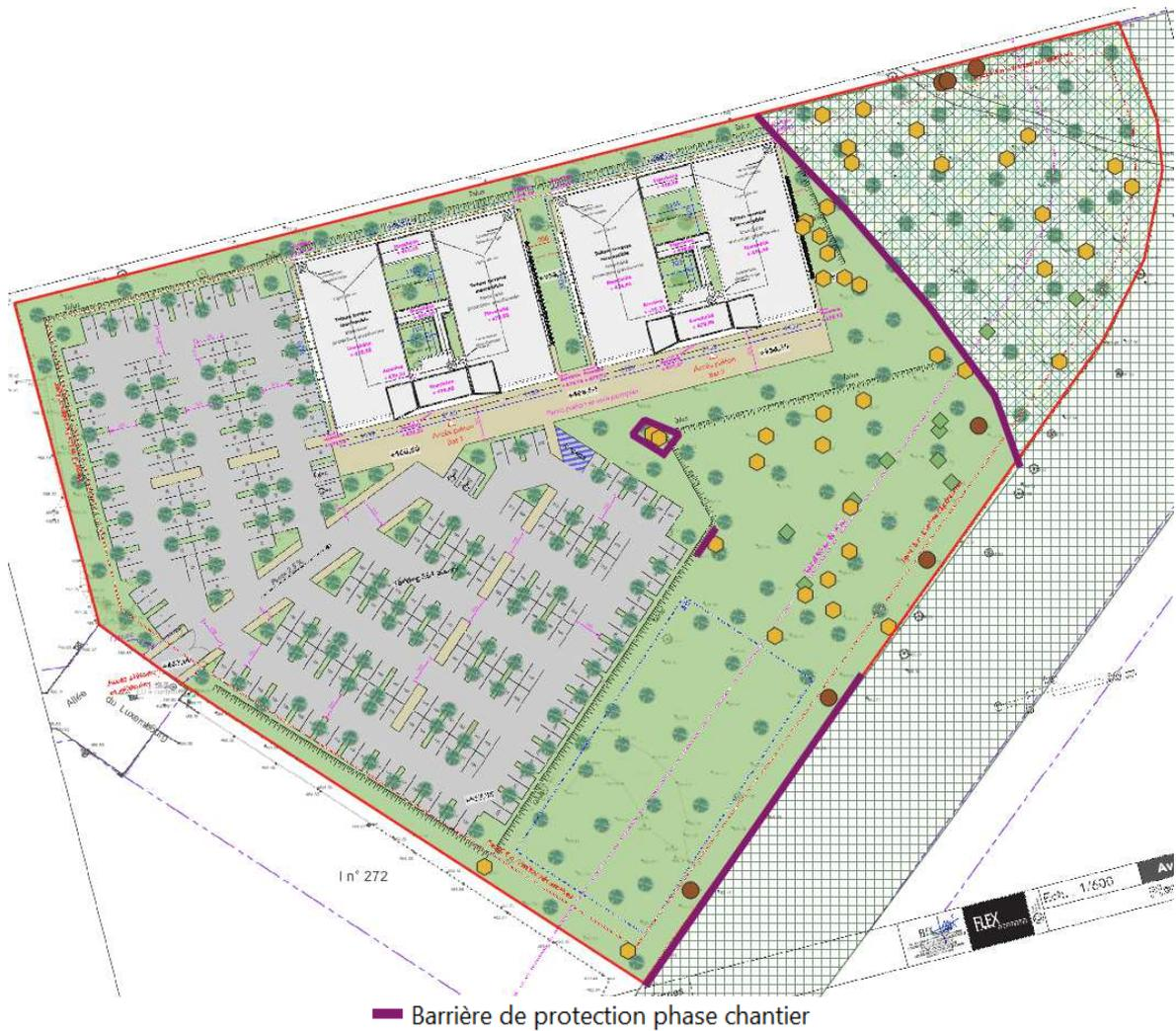
**Figure 23 : Mise en défend des secteurs d'intérêts écologiques –Phase travaux**
