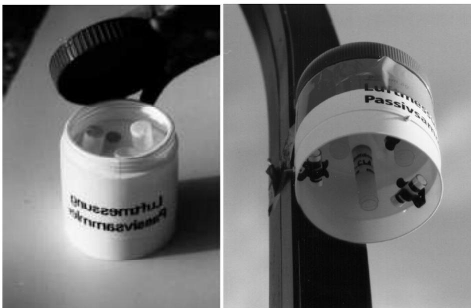
Figure 4-1 - Système de protection contre les intempéries
