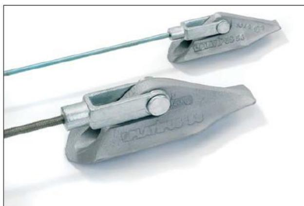
Chaque ancre est capable de reprendre au moins 3 tonnes à l'arrachement générant ainsi un capacité globale de 6 t sur l'ancrage global soit un facteur de sécurité de 2 par rapport à l'effort appliqué.
