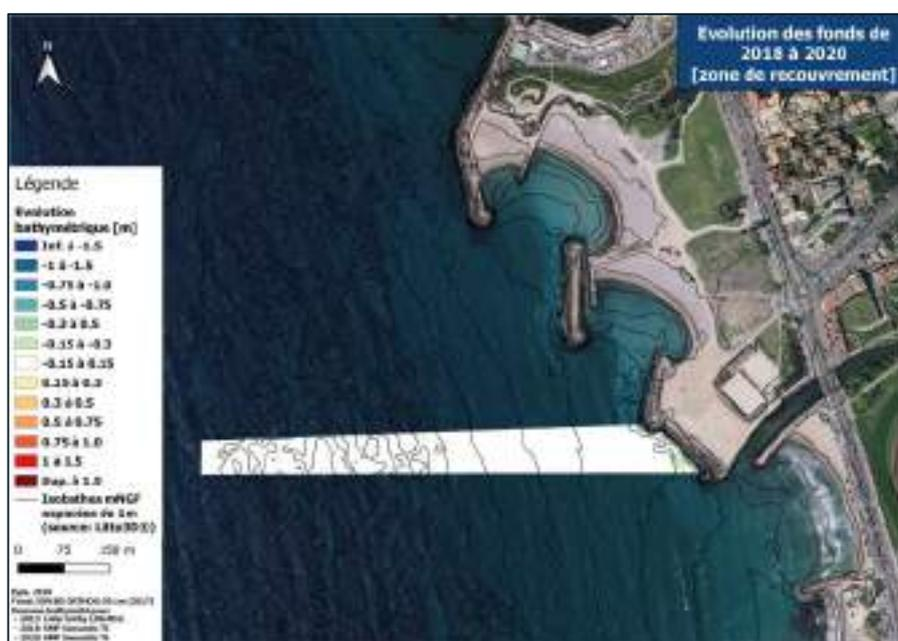
**FIGURE 25 : EVOLUTION BATHYMETRIQUE ENTRE 2018 ET 2020 SUR LA ZONE DE RECOUVREMENT DES LEVES**
