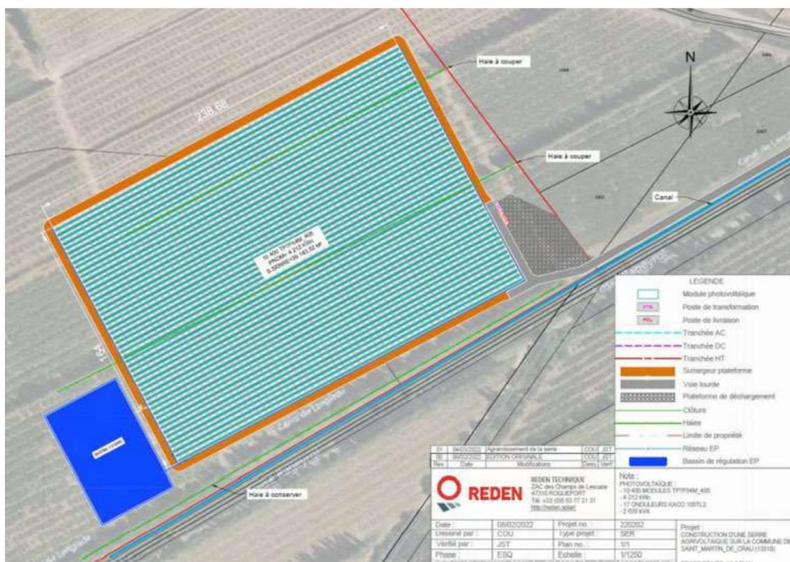
**Figure 4** : Implantation du projet : plan de la serre. Source : REDEN, 2021.
