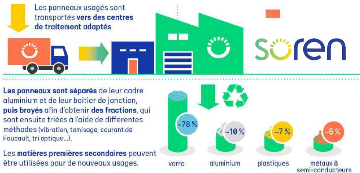
**Figure 17** : Le traitement des panneaux photovoltaïques par SOREN. Source : SOREN, en ligne.
