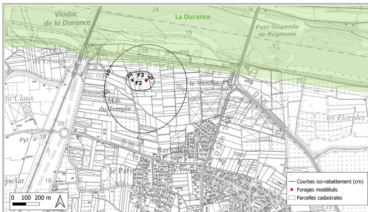
Figure 2 : Rabattement de la nappe (en cm) induit par le champ captant (300 m<sup>3</sup>/h)
