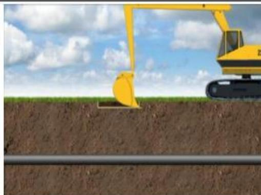
Décroûtage des enrobés (chaussée) ou décapage de la terre végétale (champ) parallèlement au réseau après vérification d'une profondeur suffisante du ou des réseaux présents.
