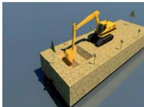
Terrassement à la pelle mécanique parallèlement à l'ouvrage, sur une profondeur de 20 cm environ (moins que la tranchée manuelle)
