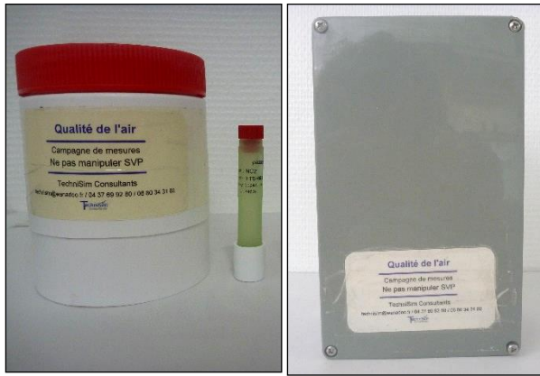
Figure 42 : Réceptacle, tube passif et micro-capteur laser
