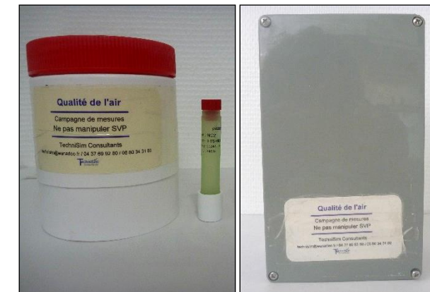
Réceptacle, tube passif et micro-capteur laser
