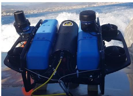
ROV avec sonar et système de positionnement
