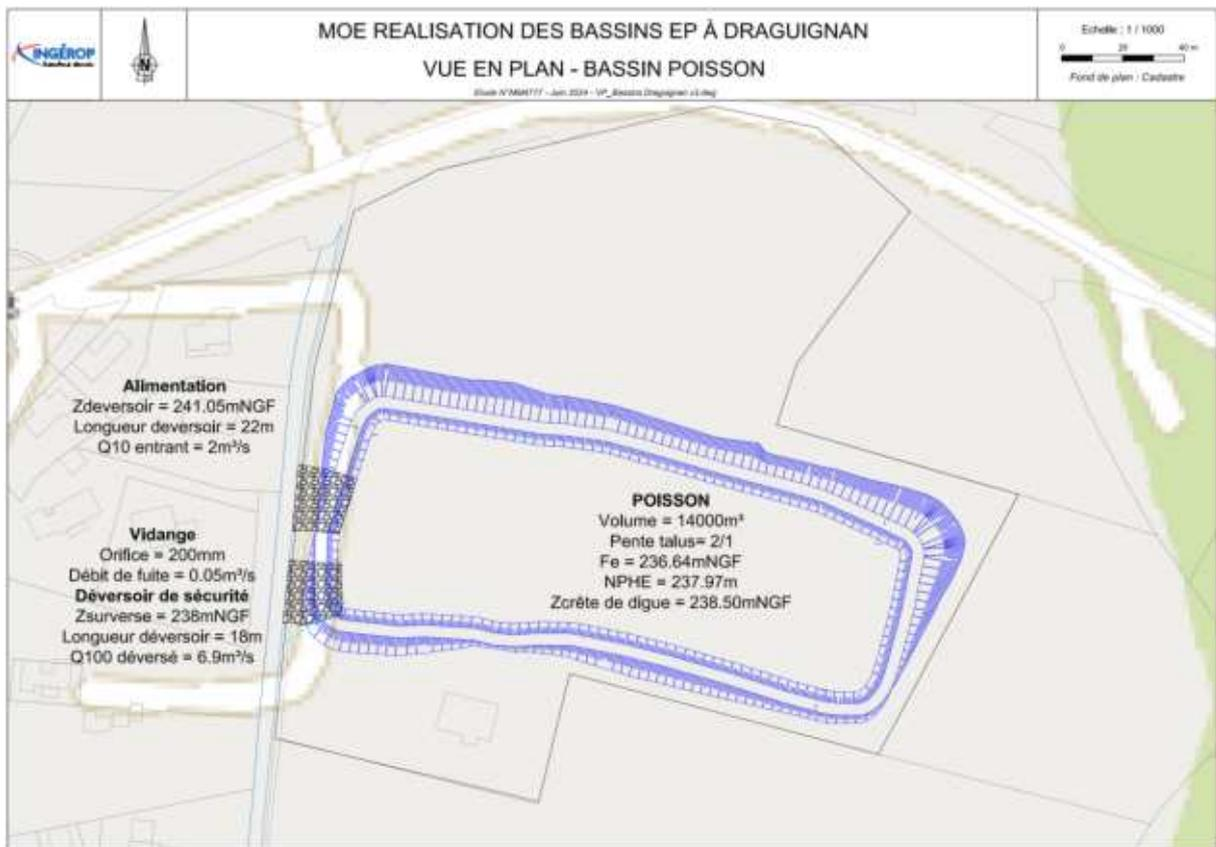
**Figure 24 : Principe de fonctionnement du bassin de rétention envisagé sur la parcelle n°424**
