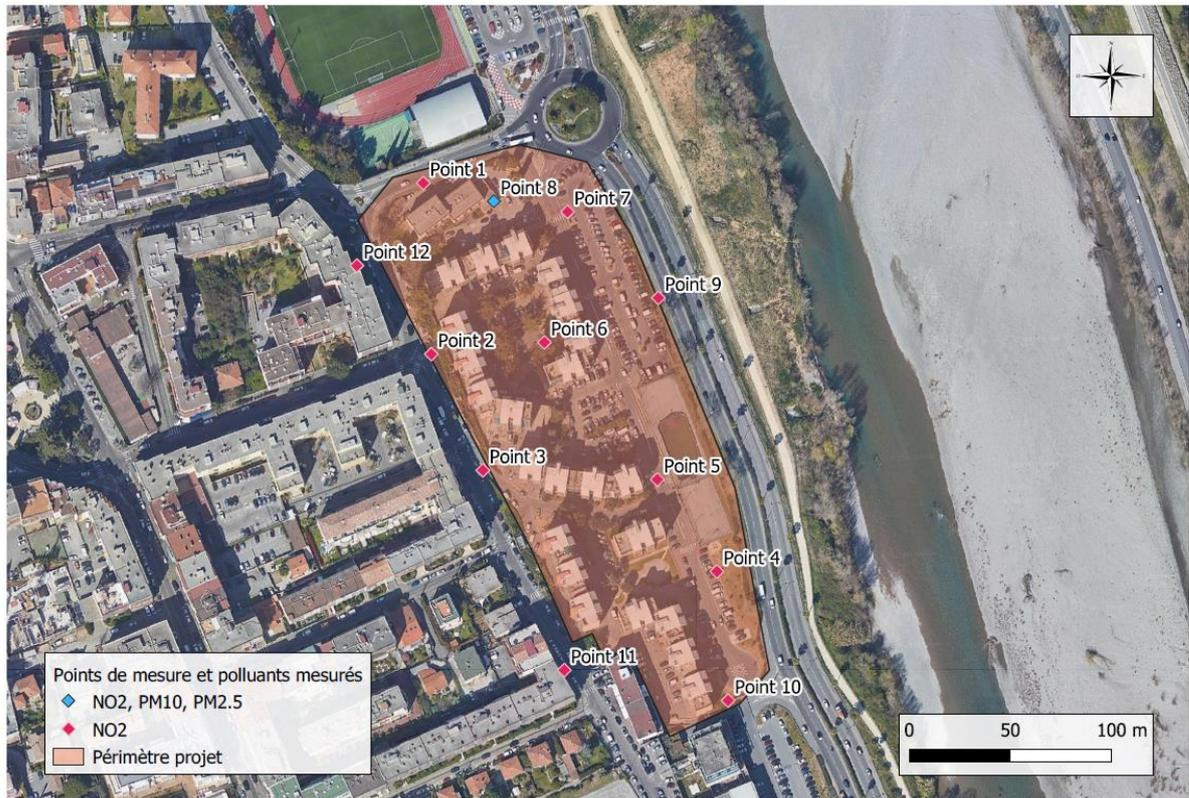
Figure 7 : Plan d'échantillonnage et polluants mesurés sur la zone du projet
