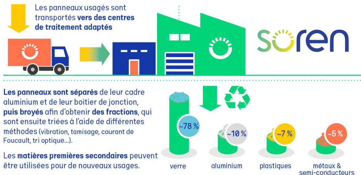
Figure 31 - Le traitement des panneaux photovoltaïques par SOREN. SOREN.
