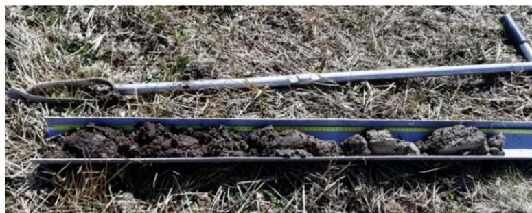
Figure 14 : Exemple de carottage réalisé à la tarière manuelle Edelman (source : EODD, 2022)
