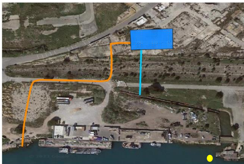
Figure 2-11 : Localisation avec vue satellite du captage (ligne orange) et du rejet (ligne bleue avec point de rejet pour CORMIX en jaune) du système de thalassothérapie dans le canal de Caronte
