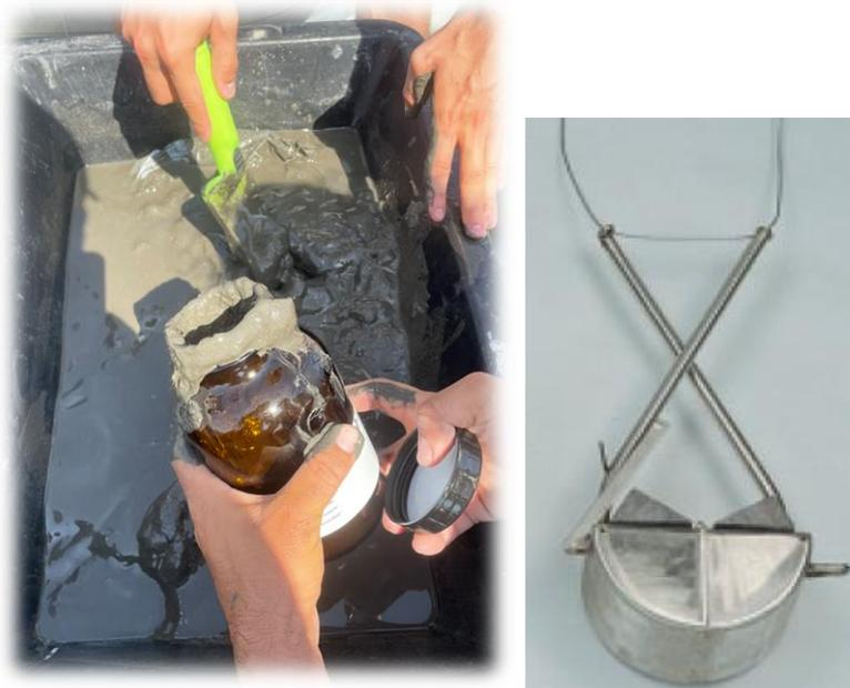
Figure 6: illustration de la méthode de prélèvement des sédiments et de la benne Van Veen.
