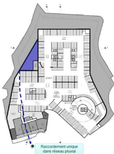
Figure 84 : Implantation de l'ouvrage de rétention
