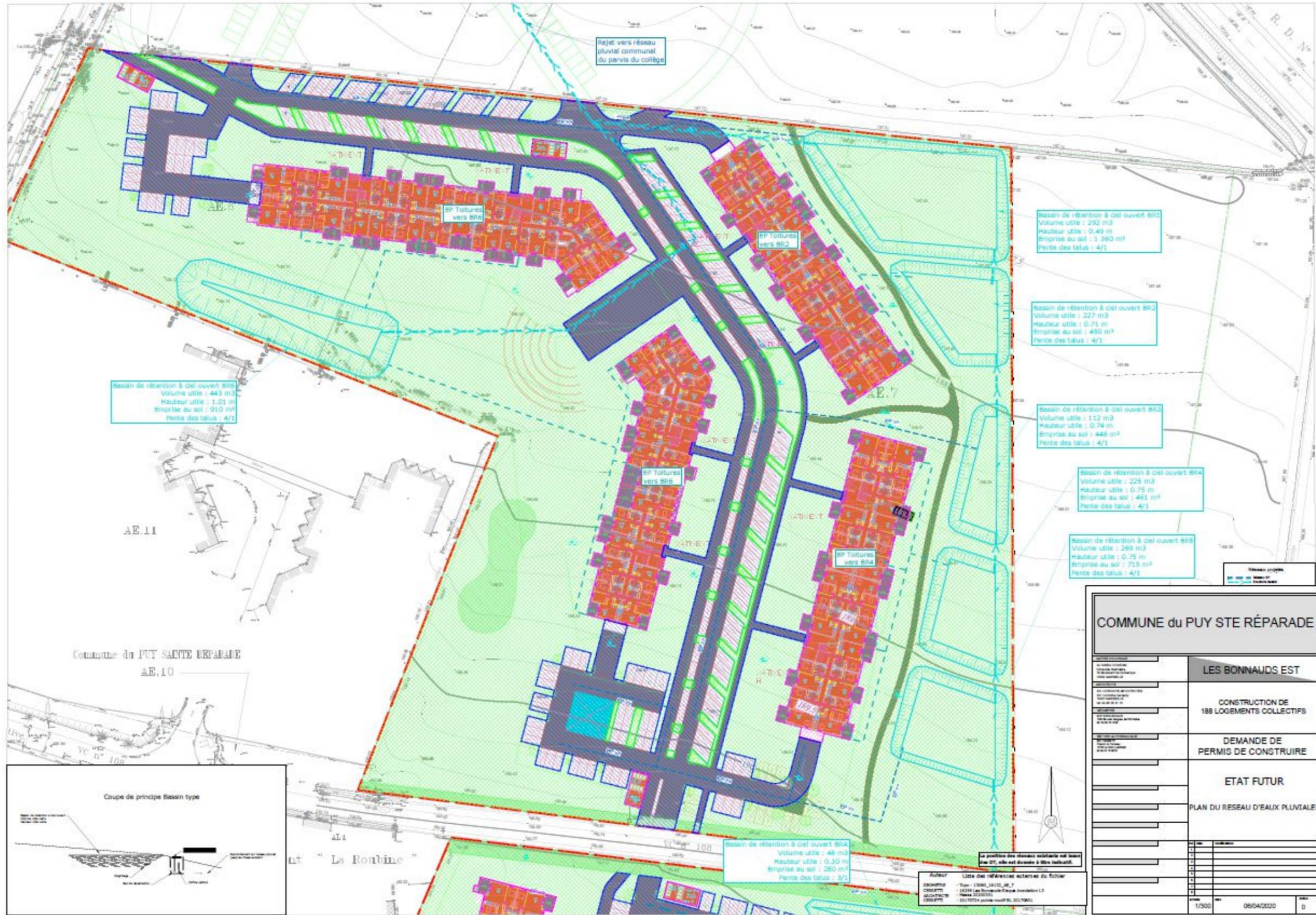
Figure 13. Plan des bassins de rétention des eaux pluviales au Nord du projet (source : Etude hydraulique CERRETTI)
