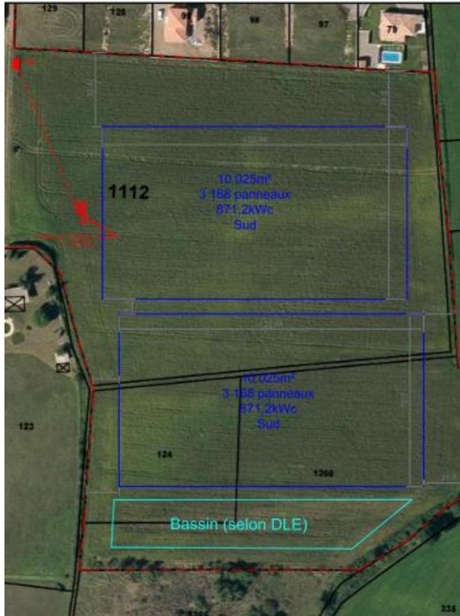
Figure 3 : Implantation du projet - 2 blocs identiques – Source Reden Solar
