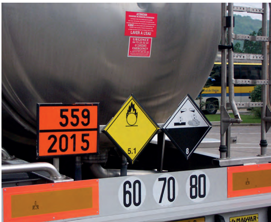
Pictogrammes TMD sur un camion : le jaune pour signifier une matière comburante et le blanc et noir pour signifier une matière corrosive © IRMA
