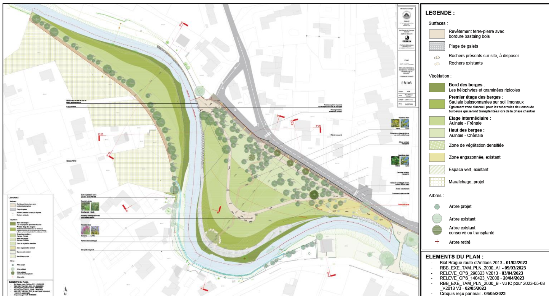
Figure 43 : Plan paysager – Plan masse global. Fourni en annexe 3 pour une meilleure lisibilité. Source : Restauration de la Brague au droit du "Hameau de la Brague" Numéro 0027 (31/05/2023) - Perrin Architectures
